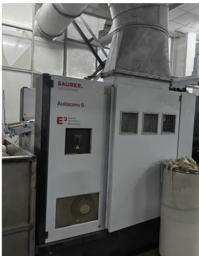
Foto 1 – Imagem da Máquina de fiar a rotor automática, Autocoro ACO 9 480, marca Saurer.
